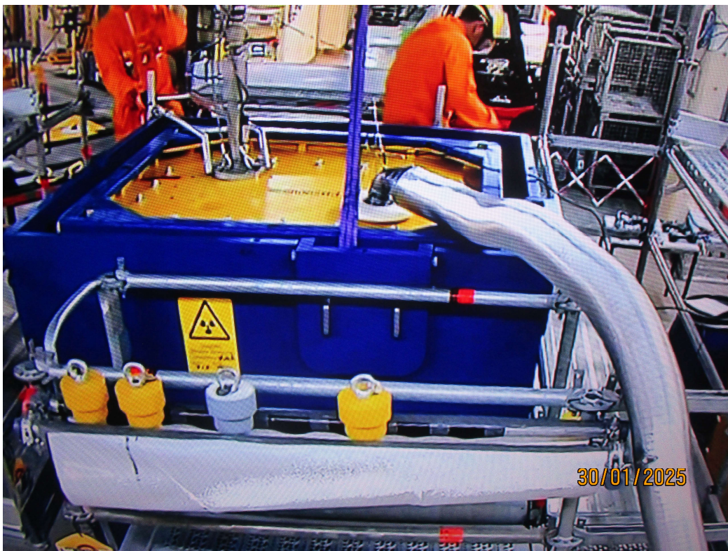
Verguss von Konrad-Container mit Beton Erster erfolgreicher Verguss am 30.01.2025
